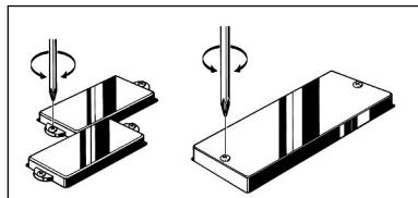
\* Gli strumenti che hanno pickup con poli regolabili possono essere regolati per bilanciare il segnale di uscita di ogni corda.
