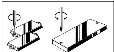
\* Los instrumentos provistos de pieza polar regulable se pueden ajustar para balancear el volumen de cada cuerda.
